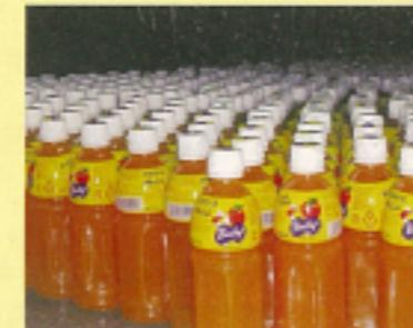
容器に詰められたばかりのバヤリースオレンジは殺菌のため温度が85度あり、それを冷却水のシャワーで一気に40度まで下げます。
