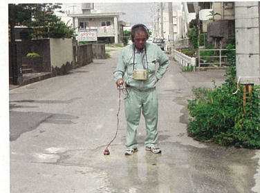
漏水探知機による調査
