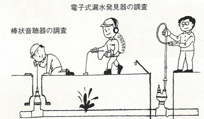
時間積分式漏水発見器の調査
