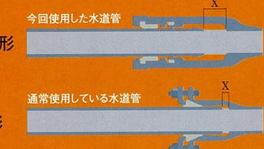
※Xのゆとりがある為、通常使用している水道管より伸縮が大きく地震や地盤のずれに強い。
